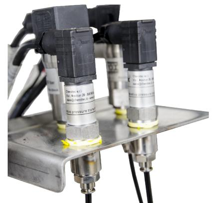
BATTERIA DI TRASDUTTORI DI PRESSIONE
